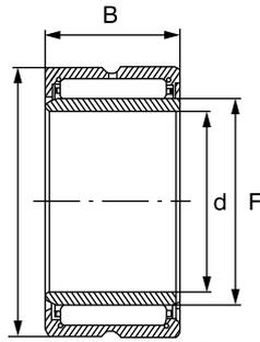
NK( $d \geq 12\text{mm}$ ) NKIS( $d \geq 8\text{mm}$ )
